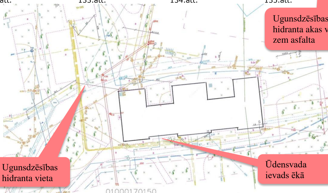
136.att. Ugunsdzēsības hidrantu izvietojums teritorijā ap ēku un ūdensvada ievada vieta ēkā
